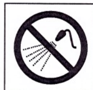
D23 - Verboden te gebruiken. Verboden te wassen met onder druk staande vloeistof.
