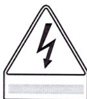
A4 - Gevaar voor elektrische schokken. Geeft de aanwezigheid van elementen onder spanning aan.
